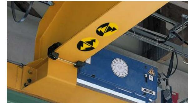
Die Unfallverhütungsvorschrift „Krane“ DGUV Vorschrift 52 (BGV D6, § 7 (1)) fordert: „Steuereinrichtungen müssen so beschaffen und angeordnet sein, dass der Kranführer den Kran sicher steuern kann. Diese Forderung ist z. B. erfüllt, wenn ... die Steuereinrichtungen so ausgebildet und gekennzeichnet sind, dass ein Verwechseln der Bewegungsrichtungen des Kranes vermieden wird, ...“
